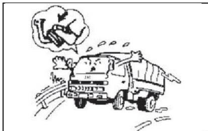
10. При движении автомобиля в сильный дождь или проезде через неглубокую реку, обратите особое внимание на вождение, поскольку тормозное усилие может временно снижаться из-за попадания влаги на тормозные механизмы.
