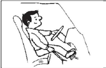
8. В целях обеспечения надлежащей эффективности торможения с помощью моторного тормоза при движении автомобиля на спуске, переключите рычаг переключения передач на понижающую передачу.
