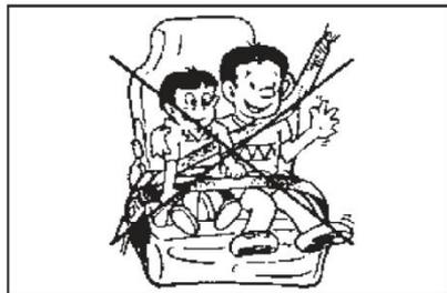
В целях избежания личных травм в момент автомобильной аварии, нельзя одним ремнем безопасности пристегивать двух людей. Избегайте износа ремня безопасности из-за закручивания или защемления ленты ремня безопасности в металлической детали и двери.
