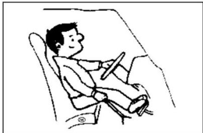
3. Переключите на пониженную передачу для замедления с помощью моторного тормоза, при использовании тормозных систем с ножным приводом будьте особенно осторожны.
