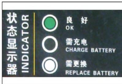
Проверяйте уровень аккумуляторного электролита, светится ли зеленым цветом индикатор степени заряженности аккумулятора.
