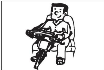
При проверке свободного хода рулевого колеса следует ставить передние колеса прямо по ходу движения, свободный ход по окружности рулевого колеса должен составлять 20-50 мм.
