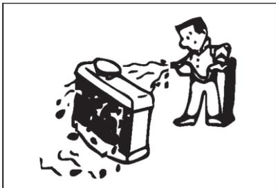
Попадание насекомых, грязи или других посторонних предметов на радиаторные пластины может привести к снижению работоспособности системы охлаждения. Регулярно проверяйте радиаторные пластины на наличие засорения, при необходимости промывайте радиаторные пластины напорной водой.
