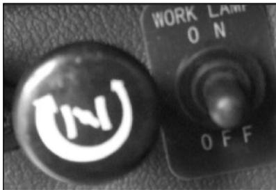
Ручка тяги ручного управления акселератором [в модели с двигателем (Евро-3/Евро-4) не применяется данная ручка]
