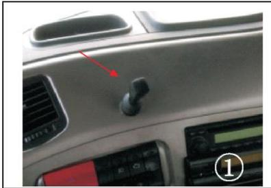
У замедления всего 7 числа передачи, то есть “0”, “В”, “1”, “2”, “3”, “4”, “5”. При регулировании позицию рукоятки замедлителя позволяет замедлитель в разном числе передачи. Рукоятка замедлителя как на картинке 1 или 2: на картинке 1 рукоятка замедлителя находится в середине панели управления, на картинке 2 рукоятка замедлителя находится между переключателем передачи и рукояткой паркировки.
