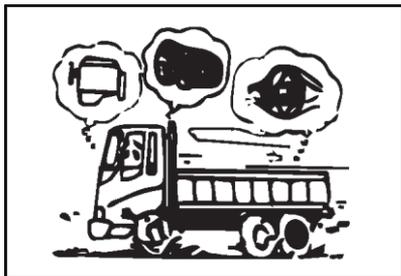
9. Во время движения по перекатам или лужам будьте особенно осторожны, в противном случае это может привести к попаданию воды в воздухопроводы, в результате это приведет к серьезному повреждению двигателя. После проезда брода следует проверить масло в двигателе, КПП и заднем мосте на наличие воды.
