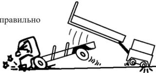
11. При буксировке следует использовать буксировочный крюк на раме, запрещается буксировать грузовой отсек.
