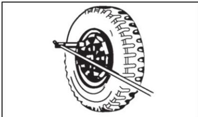
Проверяйте надежность фиксации колесных гаек.
