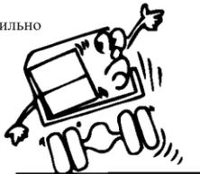
7. Крупногабаритные грузы должны размещаться в середине грузового отсека.
