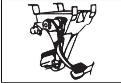
Проверьте свободный ход, рабочий ход и исправность функционирования педали сцепления.
