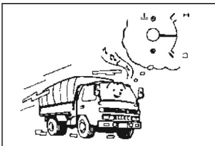
4. Во время движения автомобиля температура охлаждающей жидкости двигателя должна находиться в пределах номинального диапазона. При поступлении предупреждения о резком росте температуры охлаждающей жидкости двигателя следует как можно скорее остановить автомобиль, чтобы предотвратить серьезное повреждение двигателя.
